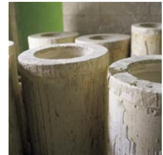
De mallen worden gebruikt voor het maken van grote potten en niet-ronde vormen. Ze worden gevuld met vloeibare klei dat na een paar dagen vanuit het midden eruit wordt opgezogen.
